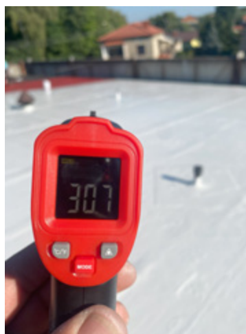
Mierzenie temperatury na powłoce z silikonu
