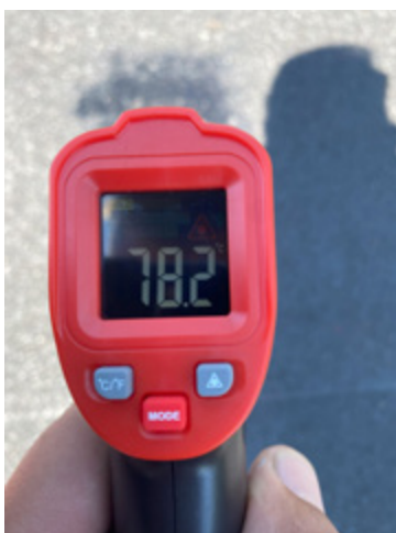
Mierzenie temperatury podłoża z papy
