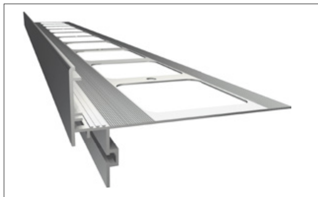
Fot. 3a, b. Wariant z drenażowym odprowadzaniem wody wymaga zastosowania specjalnych profili okapowych z otworami odprowadzającymi wodę poza połąć
