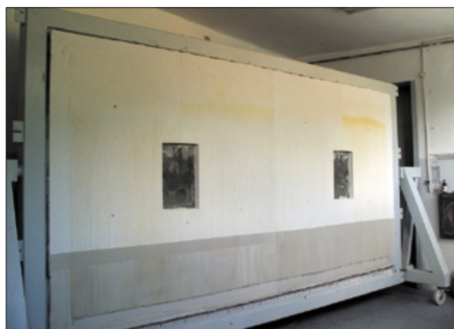
Ściana testowa ETAG 004 po testach w komorze klimatycznej Fot. SSO
