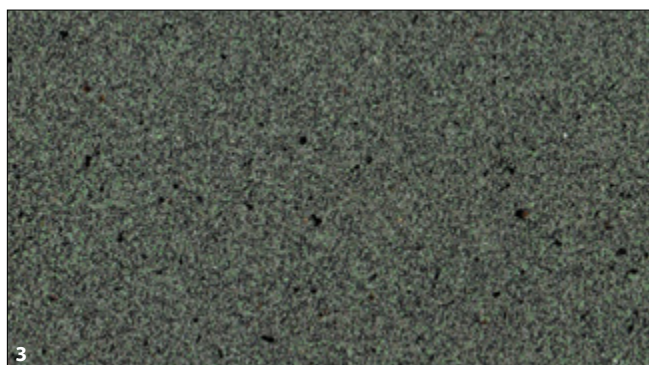
Fot. 1–4. Wyprawy zewnętrzne imitujące: tynk akrylowy – imitacja cegły ręcznie formowanej (1), tynk akrylowy – imitacja cegły (2), tynk mozaikowy – imitacja granitu (3), tynk mozaikowy – imitacja piaskowca (4) Fot. S50
