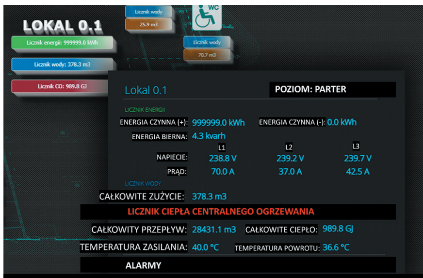
Rys. 11. Wizualizacja dla przykładowego lokalu zawierająca informacje nt. energii czynnej i biernej oraz jakości prądu. Dodatkowo w systemie uwzględniane są wskazania liczników energii cieplnej z podziałem na temperaturę zasilania i powrotu, ciepło całkowite i całkowity przepływ oraz liczniki wody /rys: EL-PIAST/
